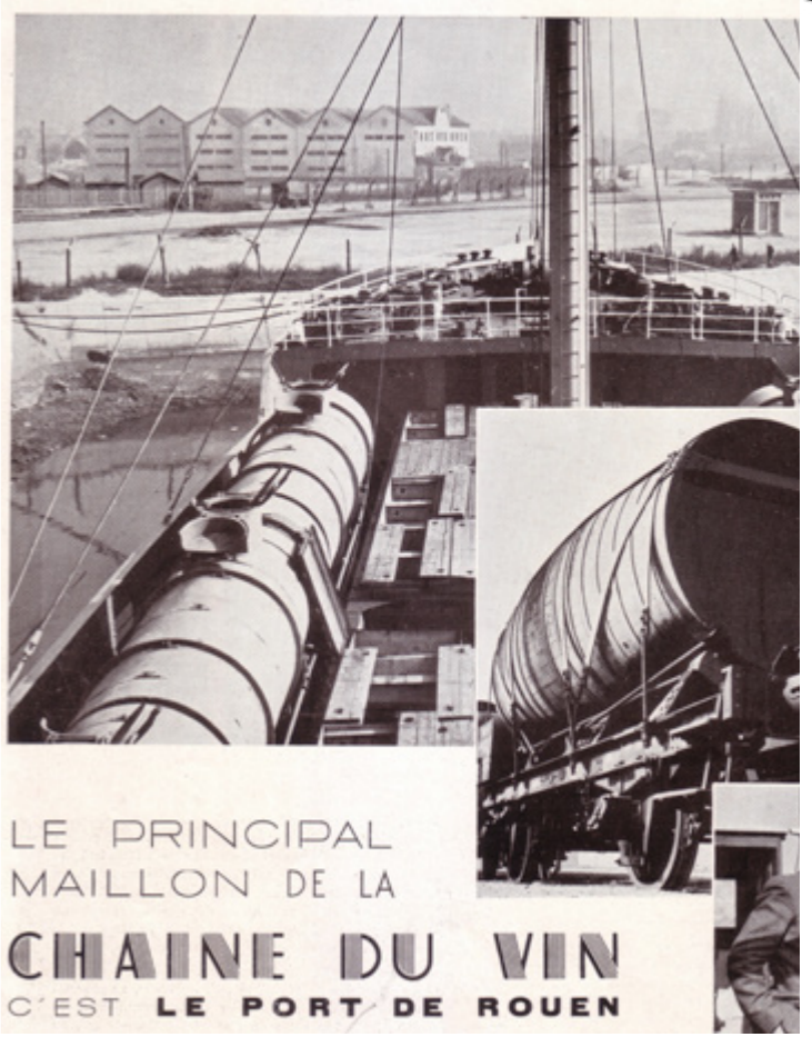
Ci-dessus : Aperçu, sur un article de la Revue de Rouen de 1947, de citernes à vin en pontée
